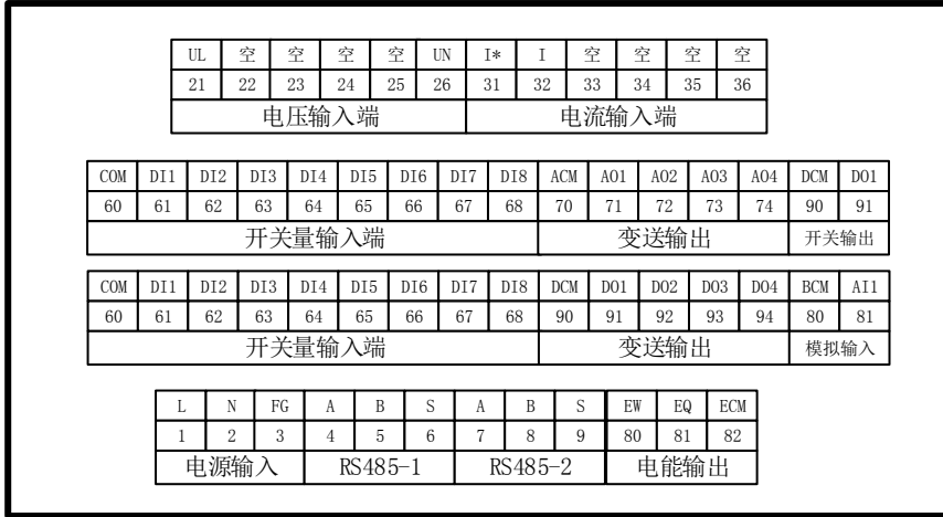
图 1 96×96、72×72 单相电力仪表接线及端子布置图
