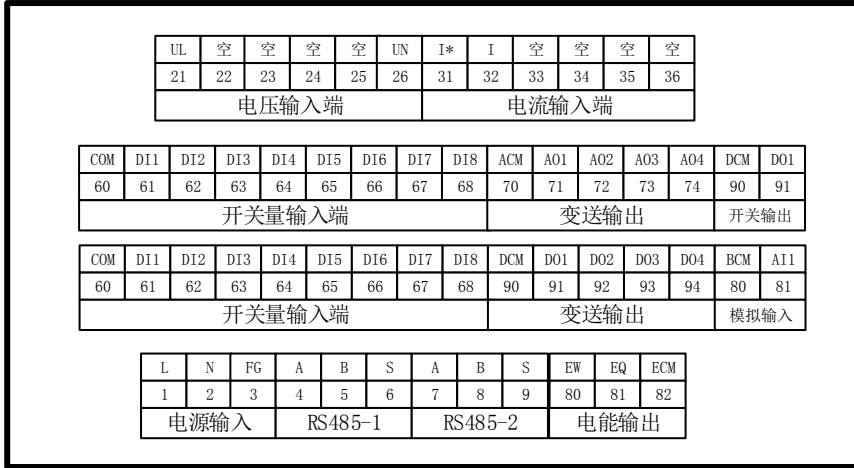
图 1 96×96、72×72 单相电力仪表接线及端子布置图
